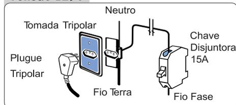
Para a Lavadora-Secadora 127V, utilize um disjuntor de 15A na fase.
