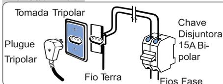
Para a Lavadora-Secadora 220V (entre duas fases), utilize um disjuntor bipolar de 15A.
